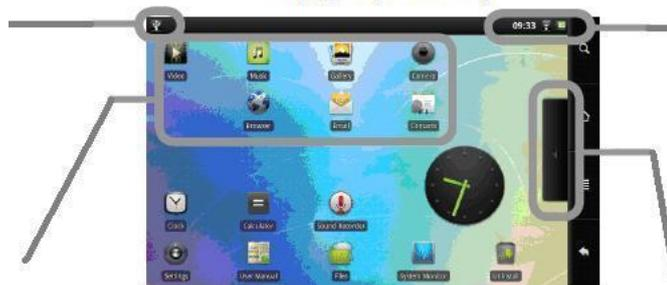
**Εικονίδια Κατάστασης:** (Ωρα, κατάσταση σύνδεσης WiFi, κατάσταση μπαταρίας, κλπ).
